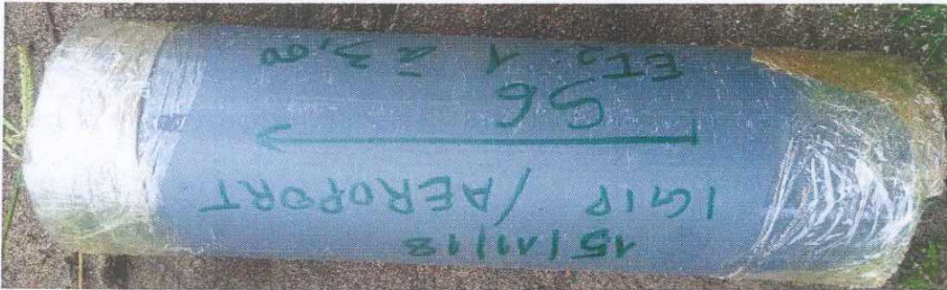
Photo 6 : Photo des couches géologiques de SC6 entre 0,00 m et 3,00 m.
