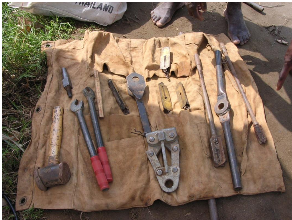
Photo 7 : Equipement pour l'essai au scissomètre.
