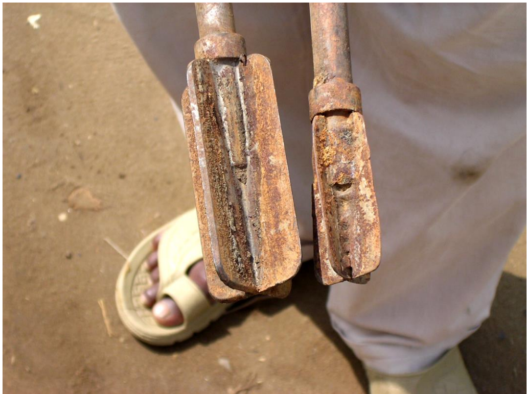
Photo 4 : Les moulinets cruciformes du scissomètre
